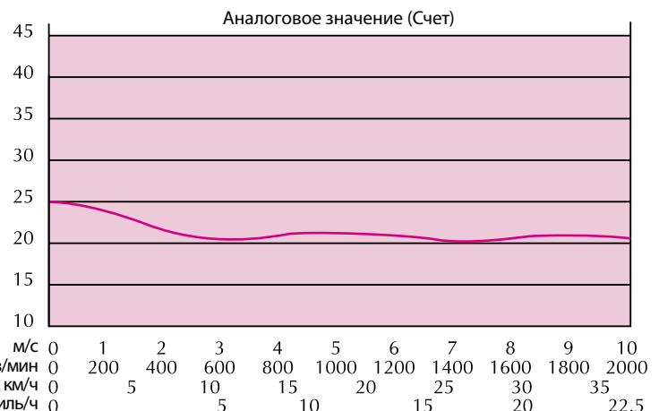
Рис.6 Типовая характеристика реакции на скорость ветра - Ионизационный дымовой пожарный извещатель серии XP95
